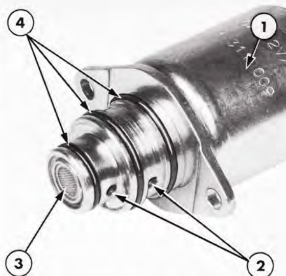
Figur 36 Solenoid og kontrollventil
