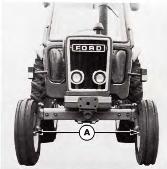
Figur 3 Maling av toe-in/toe-out A. Dimensjon mellom merkene på hjulfelgene
