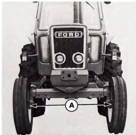
Figur 4 Maling av toe-in/toe-out A. Dimensjon mellom felgmerker
