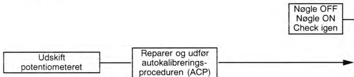
DIAGRAM 2 - Fejlkode U04 - Frontakslens potentiometers værdi ligger under den indstillede grænse
