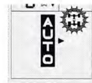
Forakslen indkoblet permanent og diff. spærre indkoblet i auto med automatisk styring ( EKS FORHJUL DREJET I + END 15 ° NÅR KØREHASTIGHEDN ER < END 10 KM/ T)
