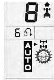
Foraksel tilkoblet i Auto-styring med diff. spærre tilkoblet permanent
