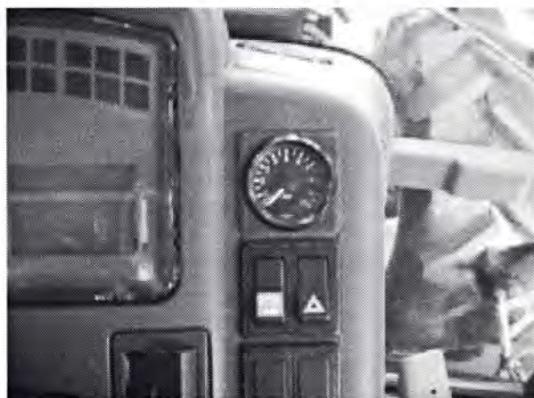
Manometer for lufttrykket
