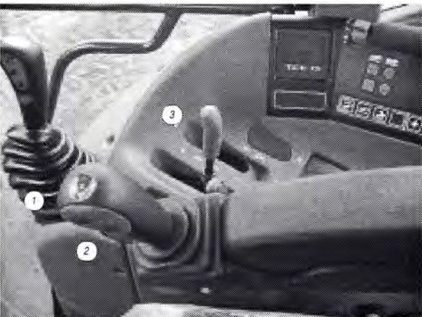
3 olieudtag: 1 betjeningsgreb på linie + 2 med joystick.
