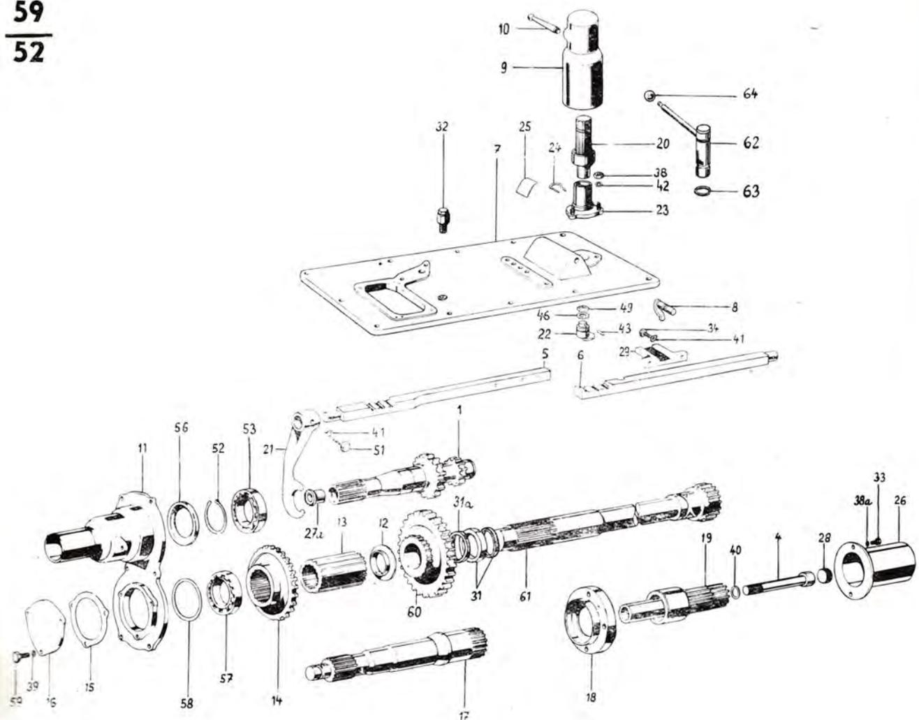
+ VÝVODOVÝ HŘÍDEL PRO 540 A 1000 ot/min.
