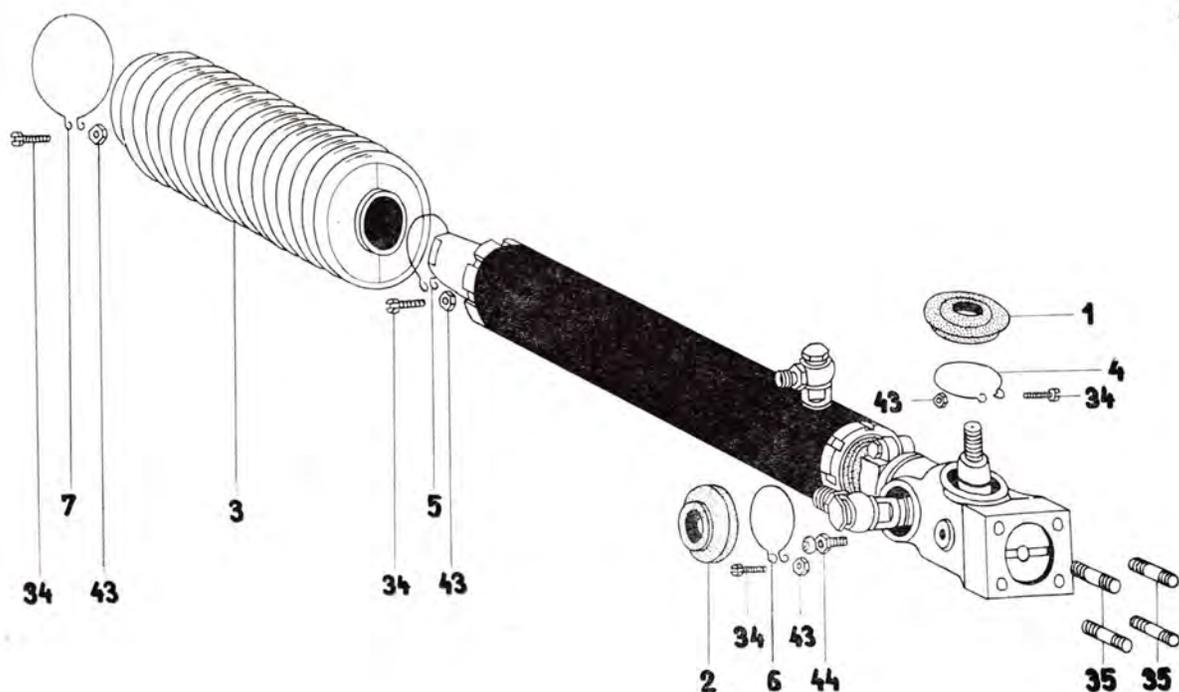
+ VÁLEC POSILOVAČE ŘÍZENÍ
