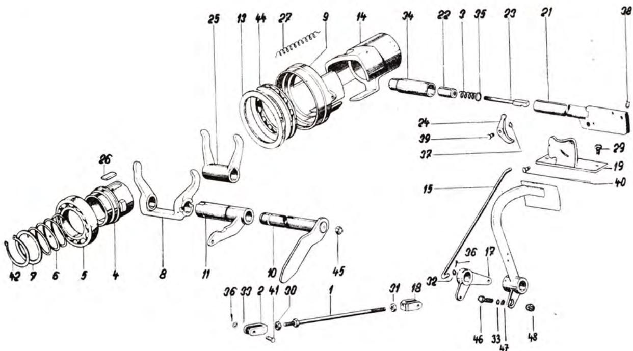
+ RUČNÍ VYPÍNÁNÍ SPOJKY VÝVODOVÉHO HŘÍDELE
